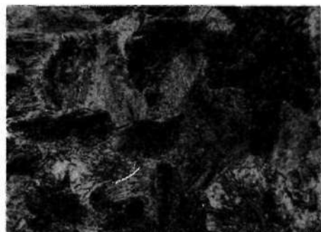
Rys. 8.17. Stal w głowa 0,80% C. Struktura ziarnista; perlit złożony z płytek, kolonie płytek ferrytu i cementytu zorientowane w różnym kierunku; nital, x250
