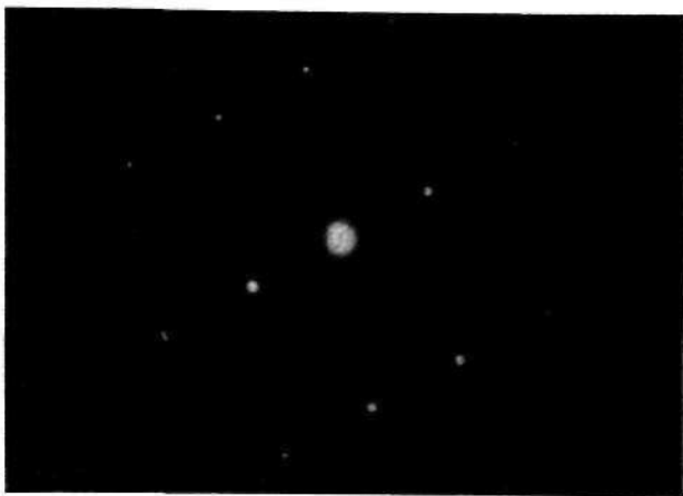
Rys. 5.18. Dyfraktogram z jednego ziarna austenitu stali stopowej
