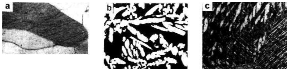
Rys. 13.14. Struktury br zów alumiiniowych: a) lany 5% Al, b) lany 10% Al (ciemny eutektoid + \gamma ), c) hartowany 10% Al. Trawiono \text{FeCl}_3 + \text{HCl} (pow. \times 200 )
