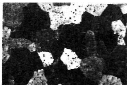
Rys. 13.8. Struktura mosi dze jednofazowego + '. Trawiono \text{FeCl}_3 + \text{HCl} (pow. \times 200 )
