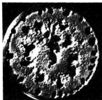
Rys. 7.29. Próbka materiału poddana kawitacji na stanowisku magnetostrykcyjnym (pow. \times 4 )
