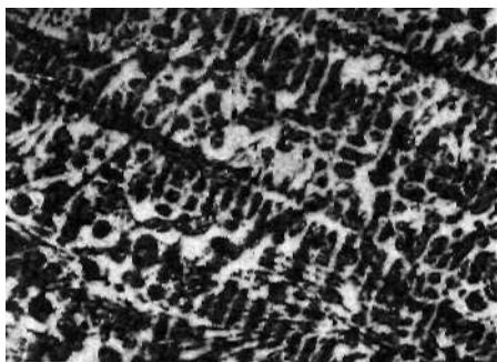
Rys. 8.39. eliwo białe podeutektyczne. Widoczne dendrytyczne ułożenie perlitu na tle cementytu; nital x100
