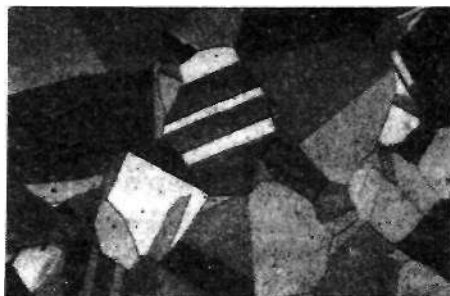
Rys. 13.5. Komórkowa budowa roztworu \alpha z bliźniakami rekrytalizacji. Trawiono
