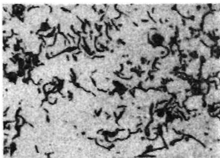
Rys. 8.30. eliwo szare nietrawione. Grafit płatkowy zwichrzony; x100
