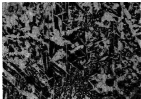
Rys. 8.27. Staliwo LU450 o zawartości 0,3% C; nital, a) jasny ferryt w postaci pierwotnych wydzieleń i struktura Widmannstättena x250; b) struktura Widmannstättena; x100
