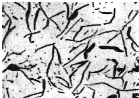
Rys. 8.29. eliwo szare nietrawione. Grafit płatkowy prosty; x100
