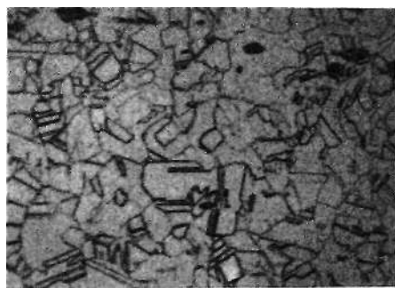
Rys. 8.20. Stal stopowa 1H18N9. Struktura ziarnist; jasne ziarna austenitu z utworami bli niaczymi, ciemne — wtr cenia niemetaliczne; woda królewska, x250
