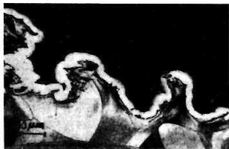
Rys. 7.22. Wzniesienia i wgł bienia na powierzchni miedzi. Trawiono \text{FeCl}_3 + \text{HCl} (przekrój poprzeczny próbki materiału)
