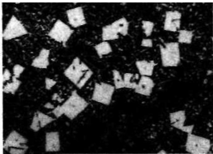
Rys. 17.5. Stop ło yskowy Ł16. Jasne kryształy fazy mi dzymetalicznej \text{SbSn} w postaci wielokątów i drobne \text{Cu}_2\text{Sb} na tle ciemnego roztworu stałego \text{Sn} i \text{Sb} w ołowiu; nital, \times 250
