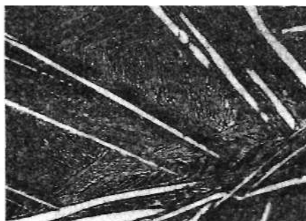
Rys. 8.42. eliwo białe nadeutektyczne. Cementyt pierwotny w postaci jasnych igieł na tle iedeburytu przemienionego; nital x250
