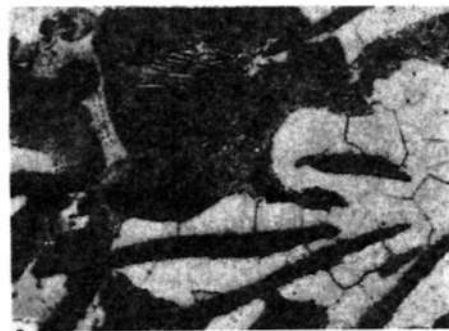
Rys. 8.34. eliwo szare ferrytyczno-perlityczne. Ciemny na tle ferrytu — grafit płatkowy, szary z pasmami — perlit; nital, x250
