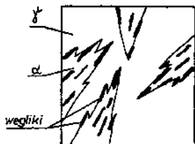
Rys. 10.6. Schemat budowy bainitu górnego
