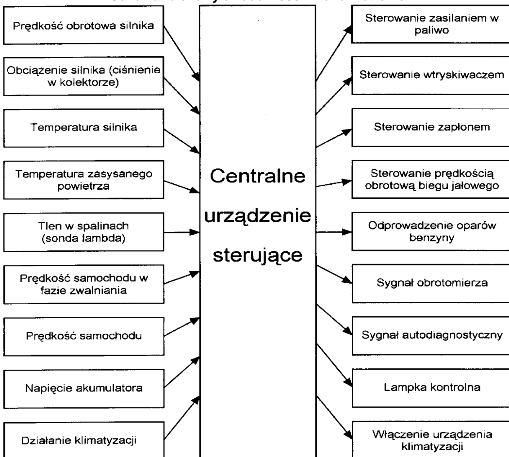
Schemat blokowy układu Bosch Mono-Motronic
