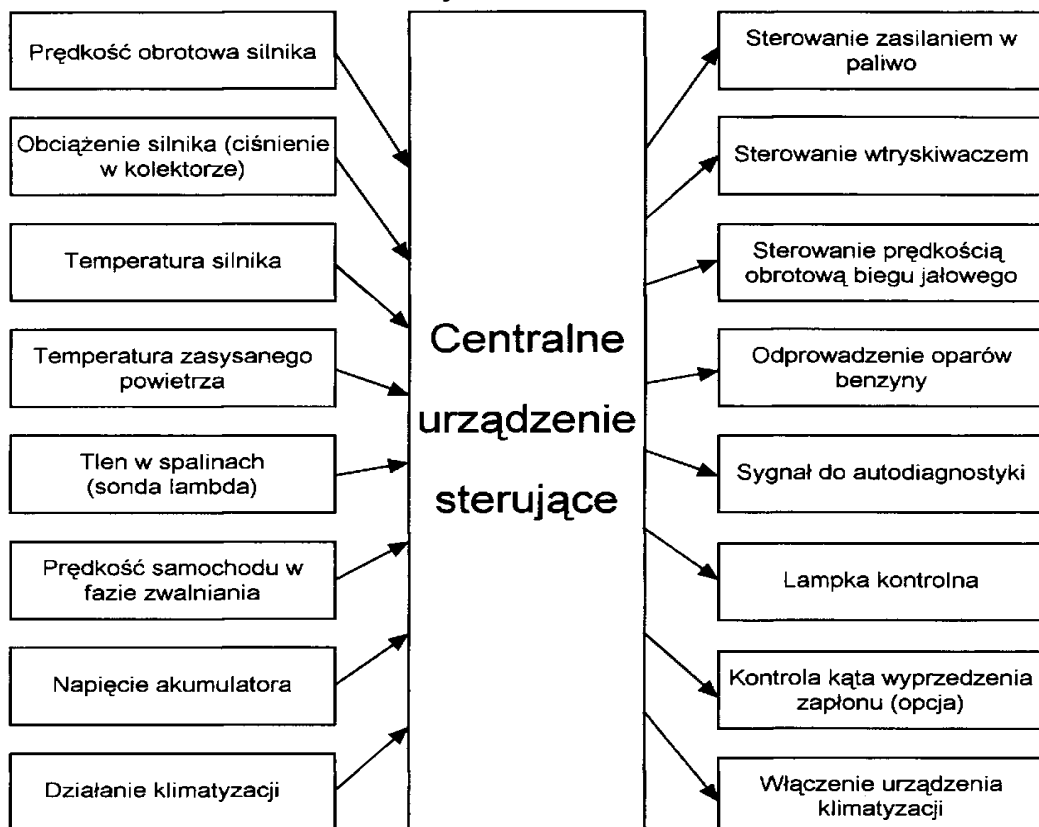
Schemat blokowy układu Bosch Mono-Jetronic
